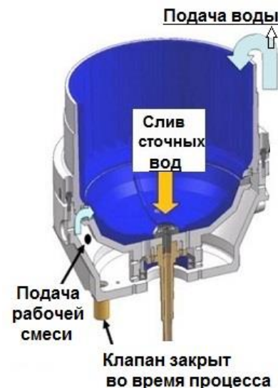
Контейнер с зазором 0 мм
