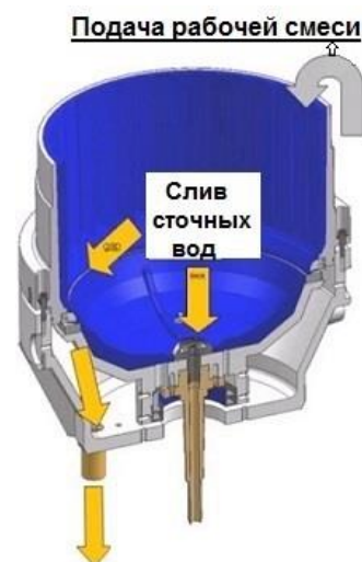
Контейнер с зазором 0,4 мм
